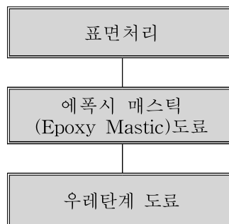
&lt;그림 5.2.13&gt; 보수도장 방법 개요도(재도장하는 경우)
